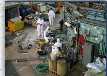
Отбор проб защитной оболочки реактора
